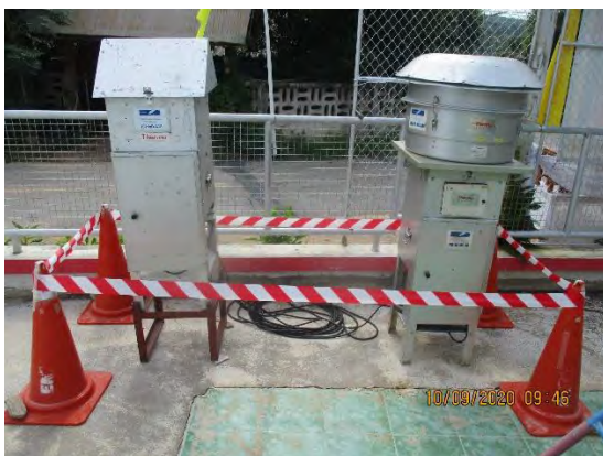
ภาพที่ 3.2.2-1 การตรวจวัดคุณภาพอากาศ ความเร็วลม และทิศทางลมบริเวณพื้นที่ศึกษาโครงการอ่างเก็บน้ำห้วยจิ้งฉงพร้อมอาคารประกอบ อันเนื่องมาจากพระราชดำริ จังหวัดน่าน
